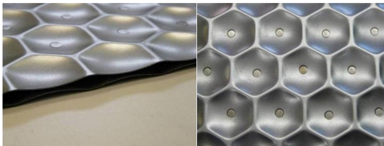
Abb.: Leichtbauelement/Halbzeug aus zwei gefügten strukturierten Blechen (links) und die eingebrachten wabenförmigen Makro-Versteifungselemente (rechts)
