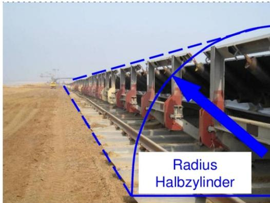
Messfläche für die Berechnung der Schalleistung einer Gurtförderanlage
