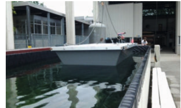
Einsetzen eines Testpontons mittels Kranbahn der BI-halle in die wasserbauliche Versuchsrinne am Laborgebäude 15 auf dem Campus Sachsendorf
