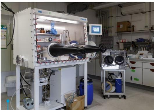
Glovebox zur Herstellung der Perowskitsubstrate, auf denen die Atomlagenabscheidung durchgeführt wird.
