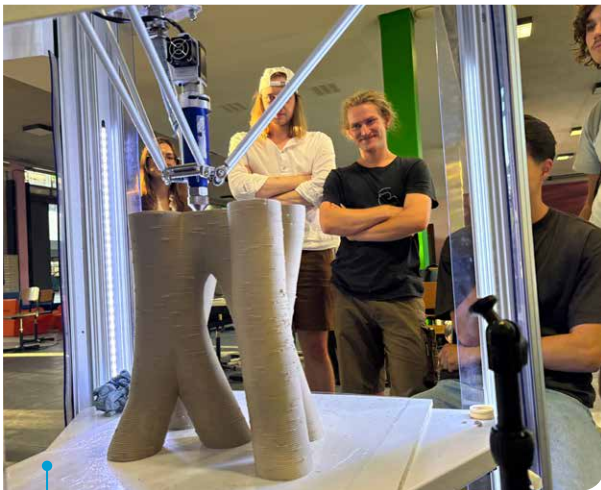
Kreative Designs – 3D gedruckt mit Ton Creative designs – 3D-printed in clay
