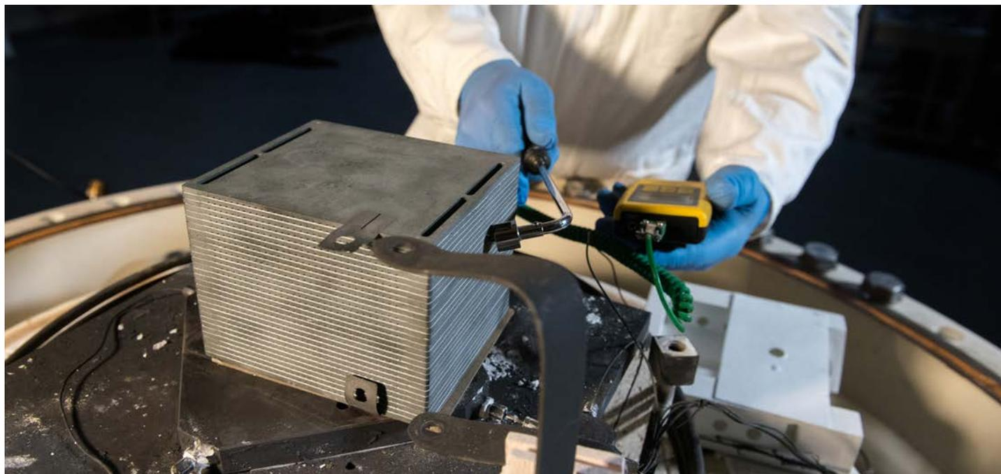
^ Temperaturmessung an der Brennstoffzelle – die für die TFC 1.0 verwendeten Hochtemperatur-Brennstoffzellen arbeiten bei Temperaturen zwischen 700 und 1000 °C
