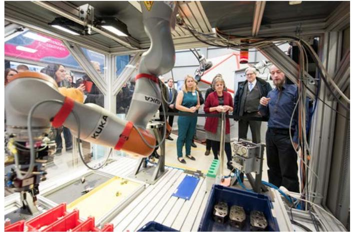
⤴ Dr. Christian Lehmann, Mitarbeiter am LS Automatisierungstechnik, erläutert die von ihm während seiner Promotion entwickelte Roboterzelle zur vollautomatisierten Montage von Hydraulikventilen. Sie entstand im Rahmen des EU-Projektes »SME robotics«
