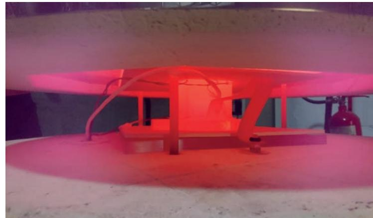
SOFC-Stack im Betrieb: Die gestapelten Brennstoffzellen arbeiten bei 700-800°C betriebssicher unter den Druckbedingungen der Mikrogasturbine (Foto: Mario Lehmann)
