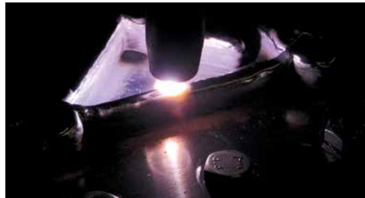
^ Der maßgeschneiderte Aluminium-Fülldraht mit Kohlenstoff-Nanostrukturen wird im Lichtbogen aufgeschmolzen und erzeugt so Schicht für Schicht das Bauteil (Foto: Lehrstuhl Füge- und Schweißtechnik)
