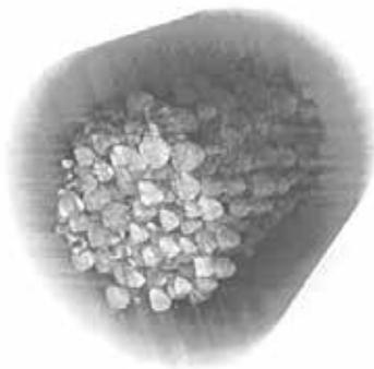
◀ Der Aluminium-Fülldraht besteht im Inneren aus einem Verbundpulverkern mit festigkeitssteigernden Kohlenstoff-Nanostrukturen (Foto: Lehrstuhl Füge- und Schweißtechnik)
