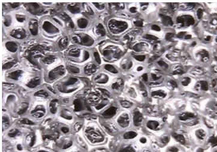
Wasserstoff-Entwicklung an Nickelschaum-Elektrode
