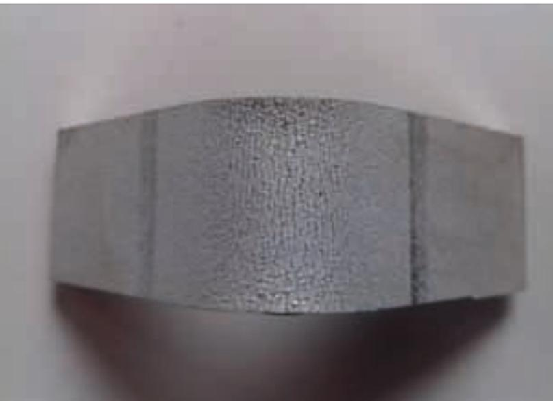
3-Punkt-Biegeprüfung eines mittels der neuen expositionsreduzierten Metallspritztechnologie beschichteten Werkstücks. (Foto: Prof. Dr.-Ing. Ralf Winkelmann)
