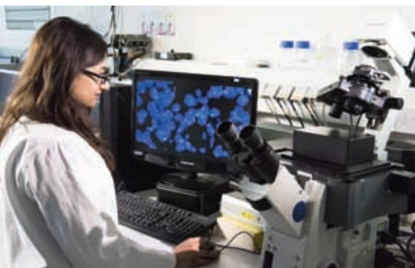
Die Studentin Vanasa Nageswaran untersucht am Inversen Fluoreszenzmikroskop in Kombination mit der VideoScan-Technologie Mutationen in einer Tumorzelllinie
