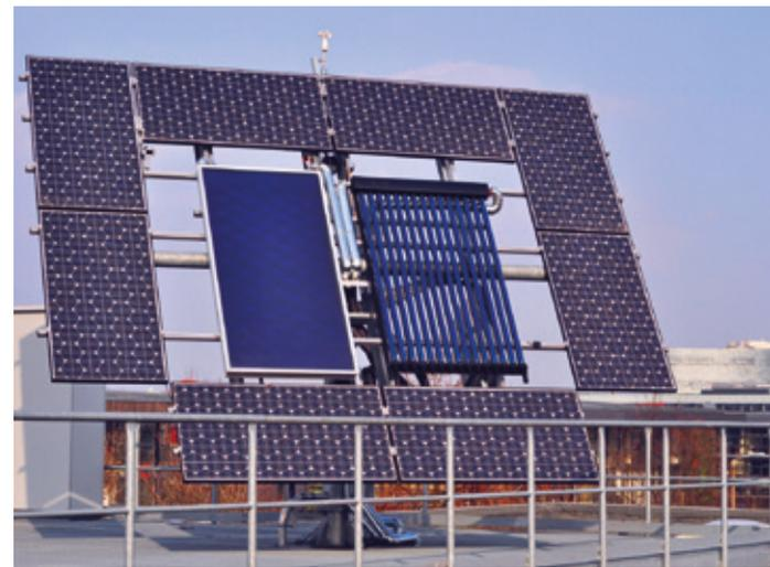
Der Komplexversuchsstand auf dem Dach des Mehrzweckgebäudes am Zentralcampus zeigt eine PV-Anlage mit Solarthermie und Nachführung
