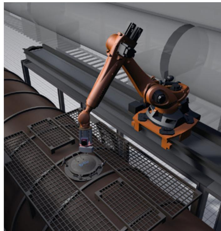
Automatisiertes Öffnen von Domdeckeln auf Kesselwagen in der Simulation
