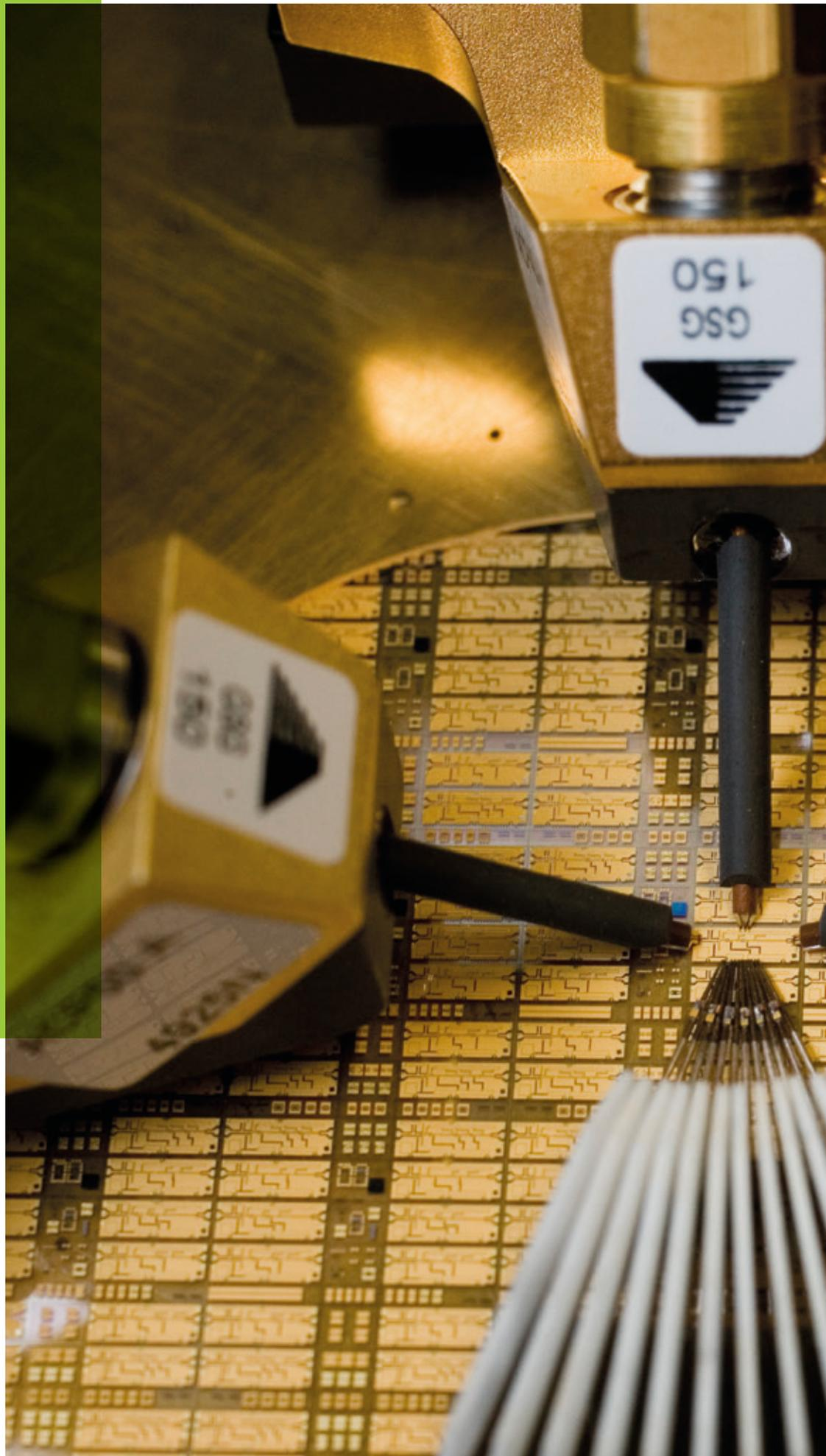
Messung eines Chips zur Qualitätskontrolle >
