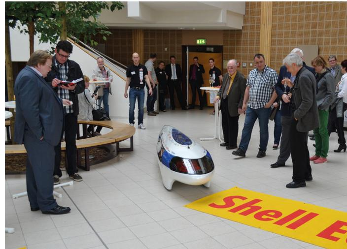
Das Auto wiegt 36 Kilogramm und besitzt eine freitragende Außenhaut aus Carbon
