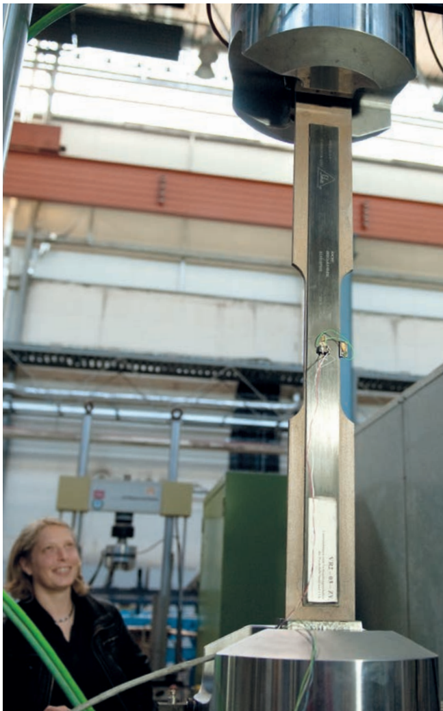
Zugversuch an einem mit CFK verstärktem Flachstahl
