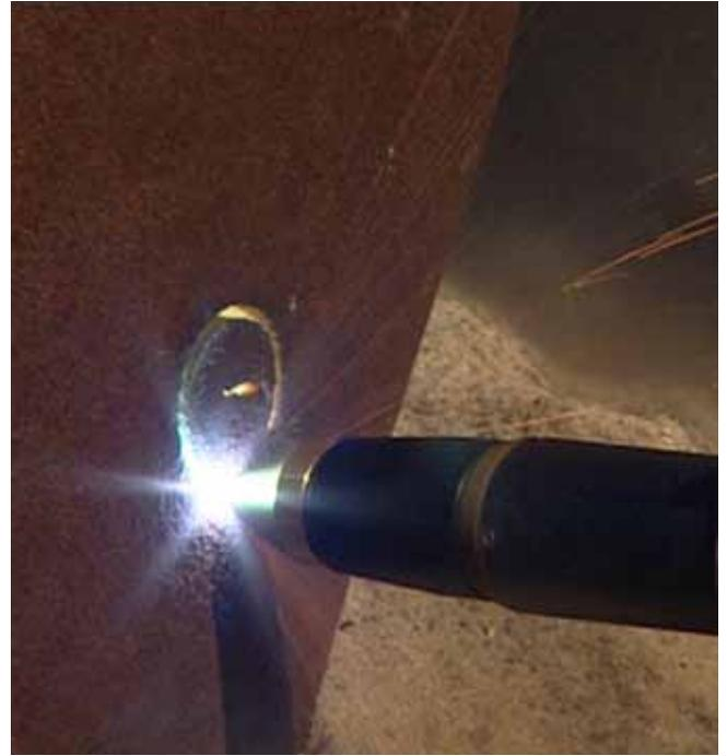
An einer originalen Bombenhülle aus Stahl werden die Rahmenbedingungen für den Einsatz der Lasertechnik getestet, wie z. B. Zeitaufwand, Wärmeentwicklung, Platzbedarf. (Foto: Kjellberg Finsterwalde)
