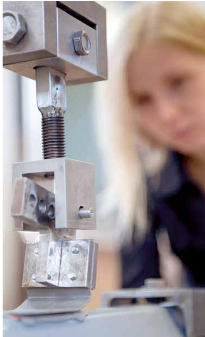
Versuch am geklebten Fassadenanschluss
