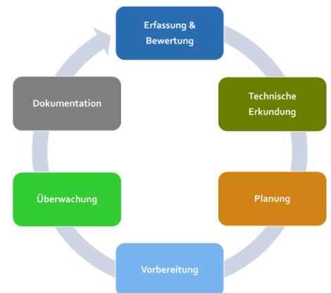
Die Abbildung zeigt eine schematische Darstellung vom Prozessablauf von der Erfassung bis zu der Beseitigung von Asbest. Zuerst muss man die Bau- und Gefahrstoffe nach Art und Menge ermitteln, bzw. eine Schadstoffklassifizierung durchführen. Dazu müssen das Faserfreisetzungspotenzial und die bauphysikalischen Betrachtungen berücksichtigt werden.
