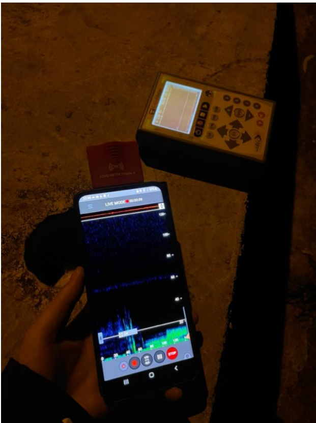
Abbildung 3: Zwei Echometer von Wildlife Acoustics zur Aufnahme von Fledermausrufen
