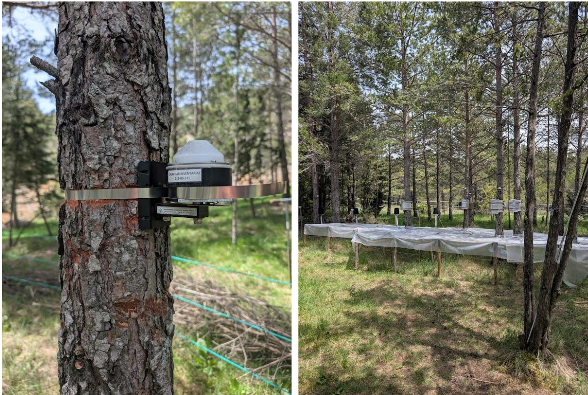
Abbildung 2: Links Messgerät um Pflanzensaftstrom (Sapflow) zu messen. Rechts: Teil des Untersuchungsgebiets in Vallcebre, Spanien
