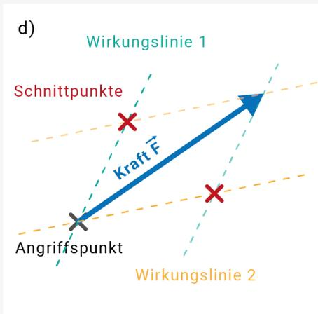
Der Angriffspunkt und die entstandenen Schnittpunkte ergeben die neuen Kraftvektoren (e).
