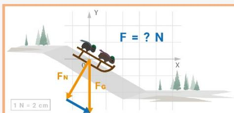
Abb.: Bildung eines Kraftecks durch die Verschiebung der gesuchten Kraft.
