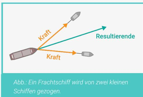
Abb.: Ein Frachtschiff wird von zwei kleinen Schiffen gezogen.
