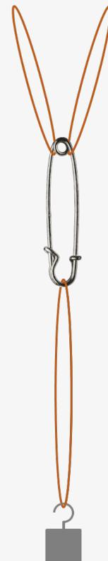
4. Vergleiche die wirkenden Kräfte miteinander. Wie verändern sich die Längen der Gummibänder (bzw. die wirkenden Kräfte), wenn der Winkel zwischen den beiden oberen Gummibändern verändert wird? Wann sind die Kräfte in den beiden oberen Gummibändern gleich groß?
