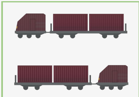
Abb.: oben: Zuglokomotive wird vor der Zug gespannt. unten: Schiebelokomotive wird hinter den Zug gespannt
