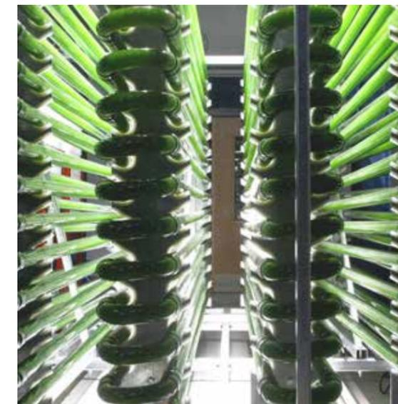
Produktion von Mikroalgen – Verbindung von Umweltschutz-Forschung durch CO2-Fixierung und Wirkstoffproduktion für biologische Grundstoffe
