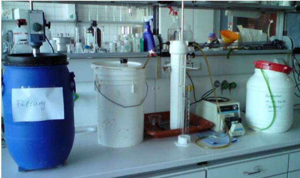
Abb. 7-4: Laborversuchsregenerierstrecke für Filterkartuschen aus der Versuchsanlage
