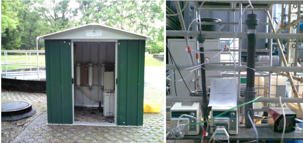
Abb. 6-1: Versuchsanlage auf einer KKA (links); 2 Baugrößen der Testfilter (rechts)
