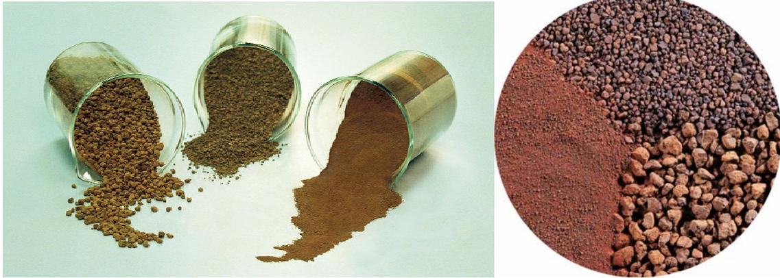
Abb. 4-1: FerroSorp<sup>®</sup> AW in den Körnungen 0-0,5 mm, 0,5-2 mm und 2,0-4,0 mm (von rechts nach links bzw. im Uhrzeigersinn)
