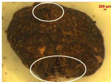
Bild 5-16: Rissbildung am Agglomerat nach der Druckbeanspruchung
