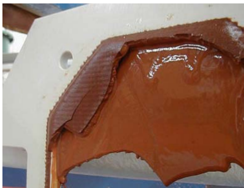
Bild 5-6: Filterkuchen des entwässerten EHS aus Lichterfeld ohne Zugabe von Flockungsmittel
