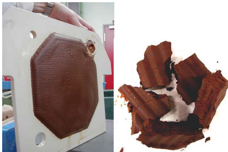
Bild 5-7: Filterkuchen des entwässerten geflockten EHS aus Lichterfeld in der Rahmenplatte links und einzelne Bruchstücke rechts
