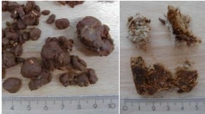
Bild 5-10: Bildung fraktaler Agglomerate durch Koaleszenz links und Faserablagerungen im Reaktionsraum rechts bei geringen Feststoffgehalten und maximaler Umdrehungsgeschwindigkeit (365 U/min)
