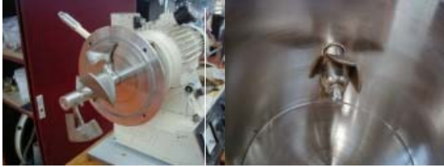
Bild 3-3: Pflugscharen und Messertulpe des Mischagglomerators
