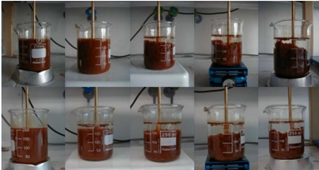
Bild 4-1: Fotografische Darstellung des Flockungserfolges mit anionischem (obere Reihe) und kationischem FHM (untere Reihe) mit zunehmender FHM-Konzentration (v.l.n.r.: 0,6, 1,19, 2,98, 4,16 und 6,55 kg FHM / t TS)
