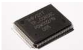
Anwendungsspezifischer Mikroprozessor der BTU (gefertigt beim Leibniz-Institut IHP in Frankfurt/Oder)
