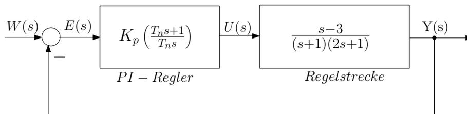
4.1 Für einen Führungssprung  $w(t) = 0.1\sigma(t)$  soll der Reglerparameter  $K_p$  des  $P$ -Reglers so eingestellt werden, dass die verallgemeinerte quadratische Regelabweichung minimal wird ( $\int_{t_0}^{\infty} e^2(t) dt \rightarrow \min$ ).
