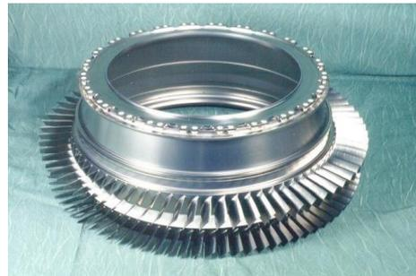
**Blisk Technologie entwickelt für den TP400 Hochdruckverdichter**
