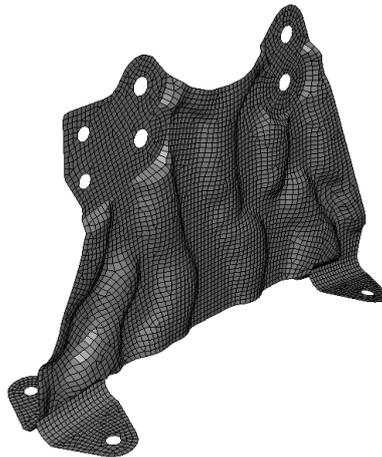
**Abb. 7.27** Ergebnis der Topographieoptimierung mit optimalitätskriterienbasiertem Algorithmus
