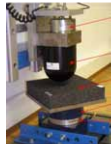
Abb.2: Versuchsaufbau Kugelaufprallversuch und FE-Modell
