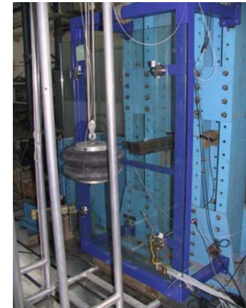
Bild 3 Der Pendelschlag- versuch nach DIN EN 12600
