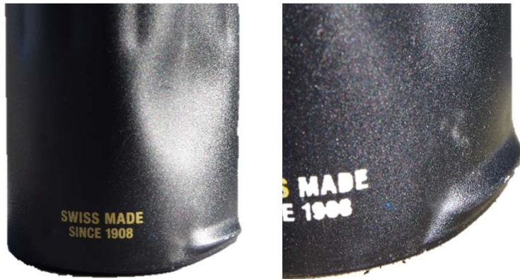
[Bild: Elefantfußbeulen einer Stahlflasche, Wolfgang Dornisch] [Image: Elephant buckling of a steel bottle, Wolfgang Dornisch]
