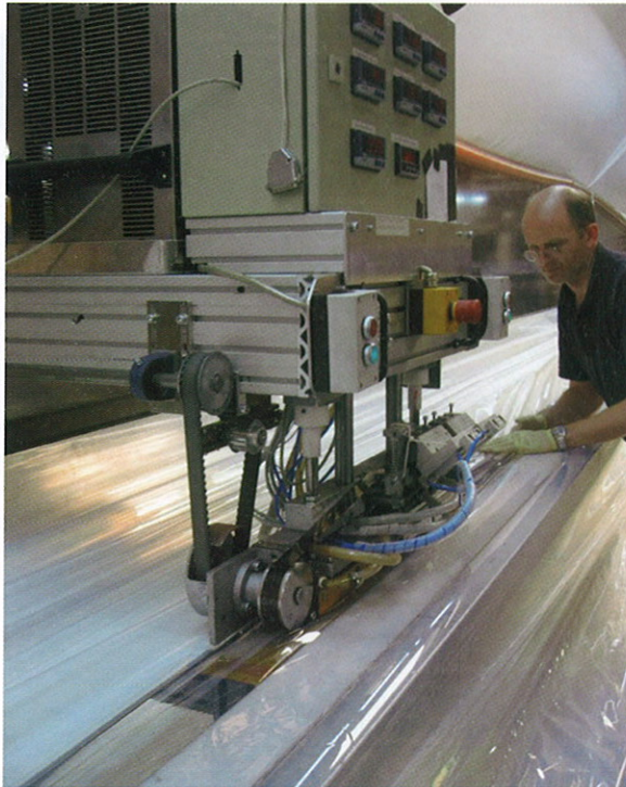
Bild 8. Bahnenschweißung Fig. 8. Welding process
