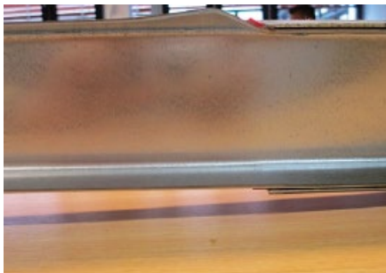
c) No separation of bonded plates in AC-U-B c) keine Trennung der Platten in AC-U-B
