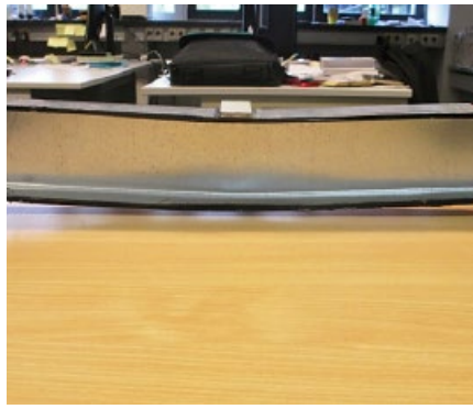
a) Deformed AC-U-B and EP-U-B girders (left); curvature of the girders (right) a) verformte Träger AC-U-B und EP-U-B (links); Trägerkrümmung (rechts)
