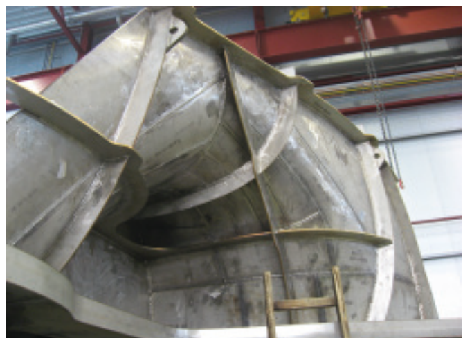
Bild 15. Segment im Eingangsbereich mit stark gekrümmten Blechen Fig. 15. Segment in the entrance area with strongly curved plates
