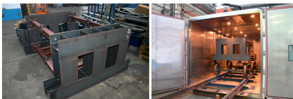
Bild 4. Versuchsrahmen, Versubvorrichtung und Einbausituation in der Klimakammer Fig. 4. Testing frame, modified rail vehicle and initial situation in the climate chamber
