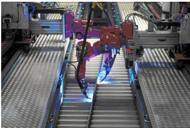
Bild 2 Schweißen von Wellstegträgern Fig. 2. Welding of sinus web beams
