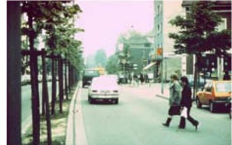
Abb.4: Einstreifig überbreite Richtungsfahrbahn (5,50 m) (Saarbrücken)
