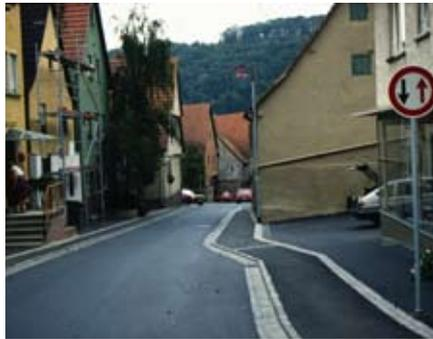
Abb.9: Die Seitenraumbreite läuft durch, der Rest ist Fahrbahn
