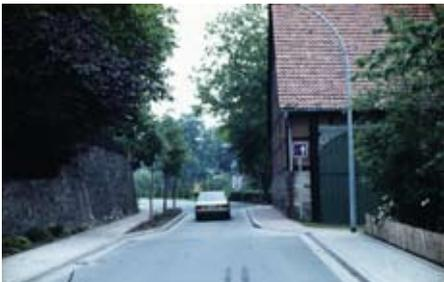
Abb.7 b: Problemlösung durch eine einstreifige Fahrbahn an der baulichen Engstelle zwischen Kirchhofmauer und denkmalgeschützter Scheune (DTV ca. 5.000 Kfz/24 h)
