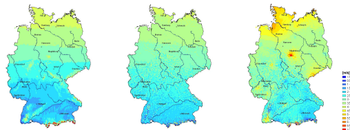
Abb. 3: Mit verschiedenen Interpolationsmethoden erzeugte Datensätze der mittleren Windgeschwindigkeit im Zeitraum 1951 - 2001. Links: Regressionsansatz, Mitte: Inverse Distance Interpolationsverfahren (IDW) und Rechts: Inverse Distance Interpolationsverfahren nach Vorverarbeitung der Daten (IDW*).
