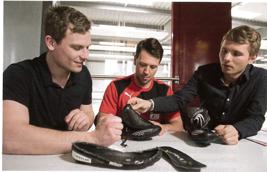
1 Die BTU-Forscher Niklas Vogt (l.) und Jonas Krenz (r.) entwickelten eine Einlegeschale für Bahnrad sportler Eric Engler (Mitte). Durch die Bewegung seines Fußes im Schuh ging bei der Startphase zu viel Energie verloren. (Fotos 1 – 3: BTU Cottbus-Senftenberg)
