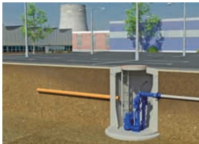
↗ Mit Hilfe von Betonpump-Schächten können Abwässer optimal entsorgt werden. Sind sie defekt, mussten bisher teure und zeitaufwändige Sanierungsmaßnahmen ergriffen werden (Foto: Lausitzer Klärtechnik GmbH)
