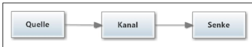
**Abbildung 1: Einfachstes Schema eines Nachrichtenübertragungssystems (Quelle: Eigene Darstellung in Anlehnung an [Göb07], S. 17)**
