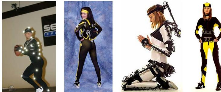
Abb. 72: MOCAP-Arten zur Datenerfassung: von links nach rechts: optisch, magnetisch, mechanisch und mit Gyroskope; aus [Tüm07]
