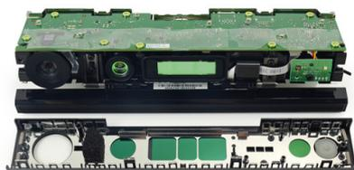
Abbildung 4: Aufbau der zweiten Kinect-Version (Quelle: [https://ifixit.com/Teardown/Xbox One Kinect Teardown/19725](https://ifixit.com/Teardown/Xbox%20One%20Kinect%20Teardown/19725))
