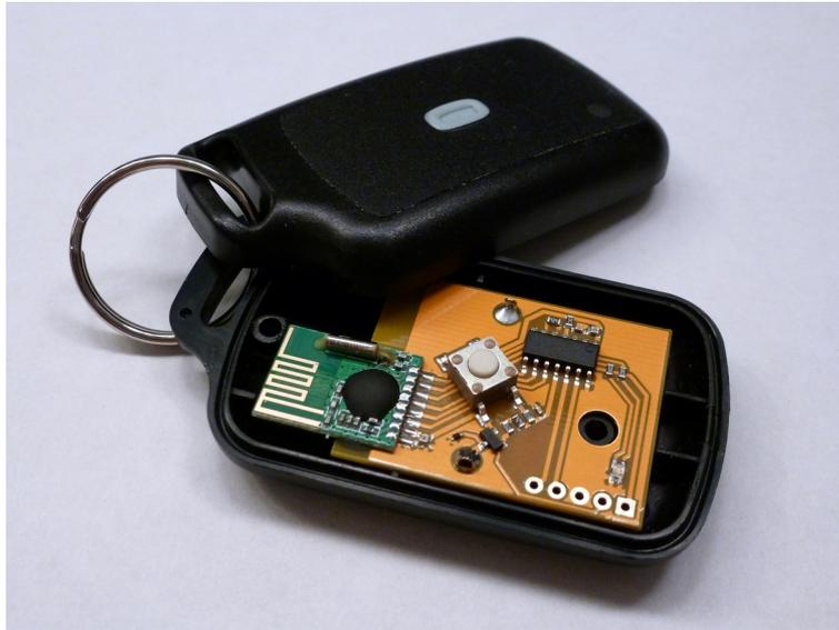
Abbildung 3: Senderplatine im Gehäuse
