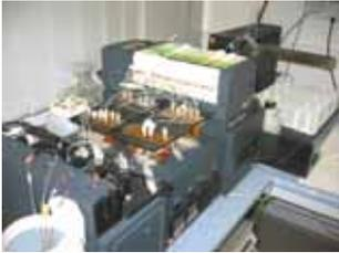
**Abb. 9:** Mehrkanal-Segmented-Flow-Analyses-Automat
