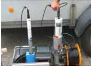
**Abb. 7:** Multiparametersonde H20
