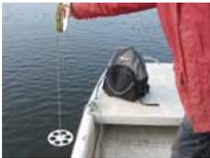
**Abb. 5:** Secchi-Scheibe zur Bestimmung der Sichttiefe.
