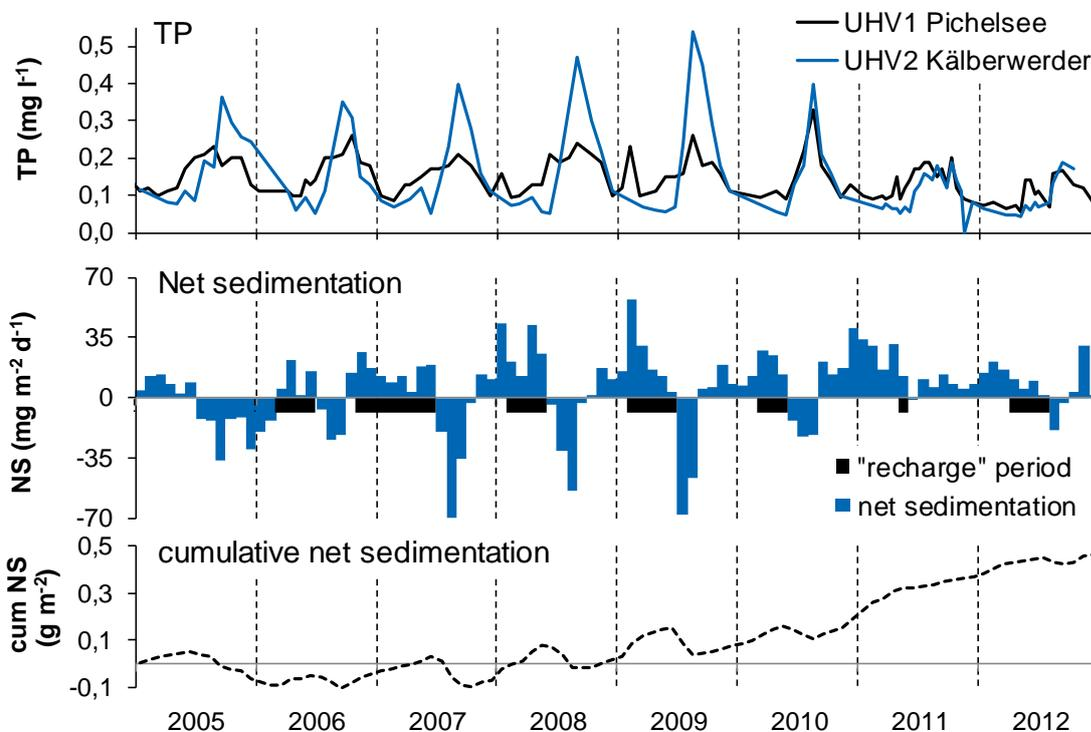
**Abbildung 13** Gesamtphosphor (TP)-Konzentration am Zulauf (UHV1) und etwa 5 km stromabwärts (UHV2), TP-Nettosedimentation (NS), kumulative NS auf Monatsbasis sowie der Zeitraum der Netto-Akkumulation (recharge period), der notwendig ist, um die nachfolgende sommerliche Netto-Rücklösung zu speisen.
