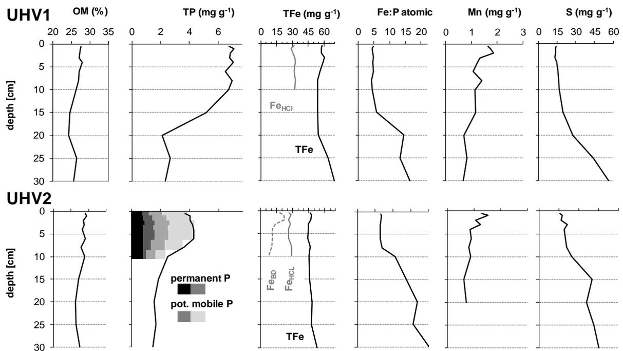
**Abbildung 14** Zusammensetzung des Sediments an den Stellen UHV1 und UHV2: organische Substanz (OM), HCl- und Bicarbonat-Dithionit (BD; nur für UHV2) lösliches Fe, potentiell mobiler P als Summe aus NaOH-NRP (nicht reaktiver organischer Anteil), BD-P and  $\text{NH}_4\text{Cl}$ -P.
