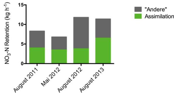
**Abbildung 24** Berechnete Anteile der (Netto-)Assimilation an der Nitratretention. Die Nitratretention ist angegeben als Umsatz pro Stunde Fließzeit berechnet über die jeweilige Gesamtließzeit der untersuchten Strecke.
