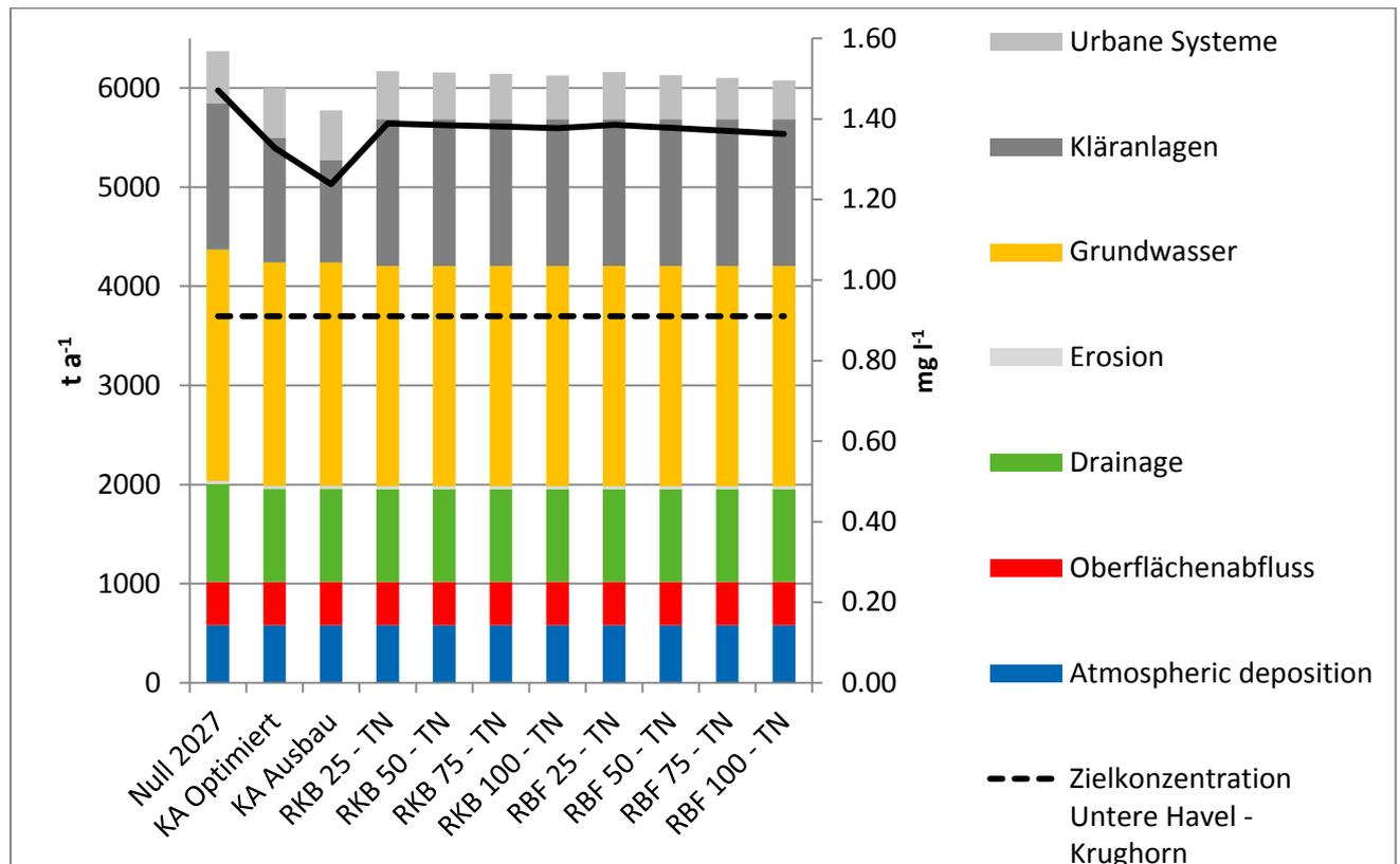
**Abbildung 13** Erzielte Einträge in  $\text{t a}^{-1}$  durch urbane Maßnahmen nach Eintragspfad und erreichte Konzentrationen in  $\text{mg L}^{-1}$  an der Unteren Havel bei Krughorn für N
