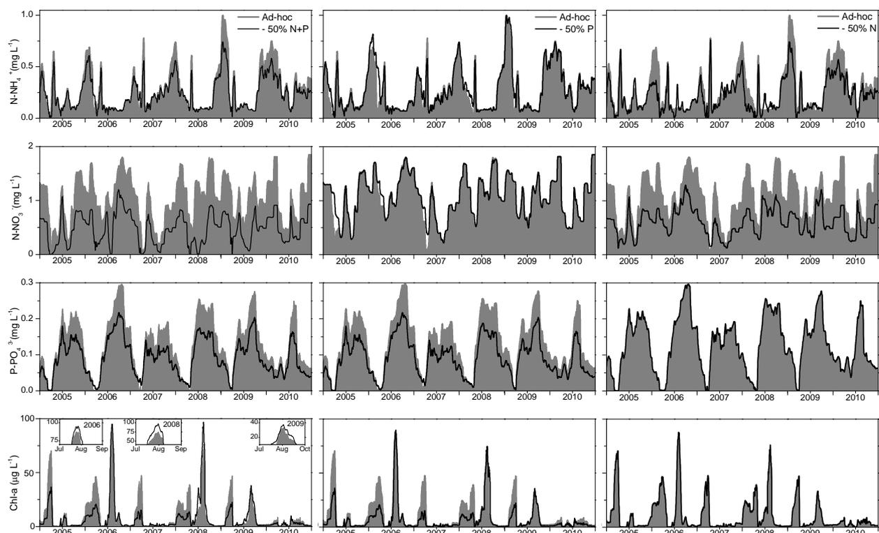
**Abbildung 18** Referenzszenario und Nährstoffreduktionsszenarien für die Untere Havel, modellierte Konzentrationen von  $\text{NH}_4\text{-N}$ ,  $\text{NO}_3\text{-N}$ ,  $\text{PO}_4\text{-P}$  und Chlorophyll-a an UHV-km 11,0. Graue Füllung: Referenzszenario, schwarze Linie: 50 % Reduktionsszenarien für N+P (links), P (mitte) und N (rechts).
