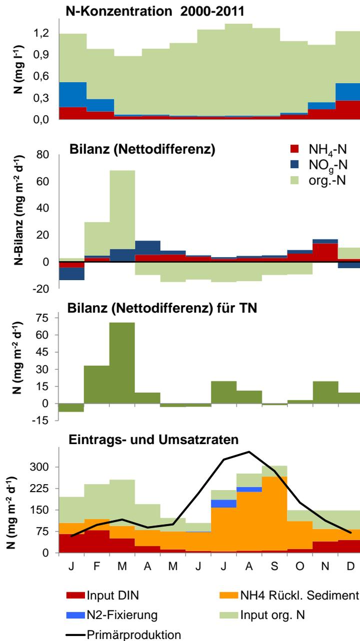
**Abbildung 28** Konzentrationsverlauf (oben) und Bilanz (Mitte) sowie Eintrags- und Umsatzraten (unten) als monatliche Mittelwerte für den Langen See aus dem Untersuchungszeitraum 2000 - 2011 für die einzelnen N-Spezies NH<sub>4</sub>-N, NO<sub>g</sub>-N, ON und TN .
