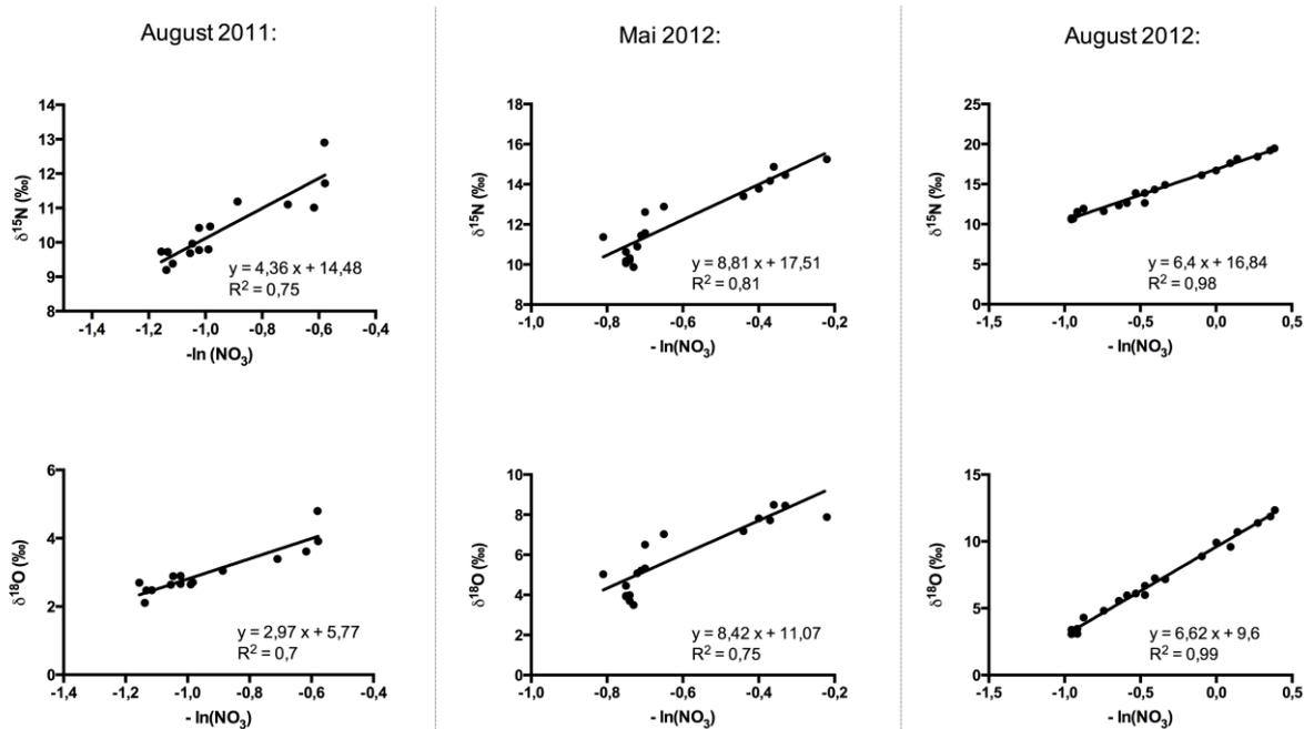
**Abbildung 25** Der natürliche negative Logarithmus der gemessenen  $\text{NO}_3$ -Konzentration im Elbewasser aufgetragen gegen die entsprechenden  $\delta^{15}\text{N}$ - $\text{NO}_3$  und  $\delta^{18}\text{O}$ - $\text{NO}_3$  Werte. Die Steigung entspricht den jeweiligen Fraktionierungsfaktoren in ‰.
