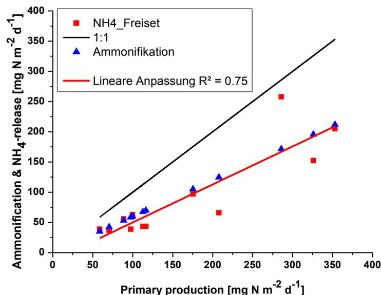
**Abbildung 29** Ammonifikation (kalkuliert als 60 % der Primärproduktion) und gemessener  $\text{NH}_4$ -Freisetzung aus dem Sediment in Abhängigkeit von der Primärproduktion im Langen See. Lineare Anpassung für Ammoniumfreisetzung.
