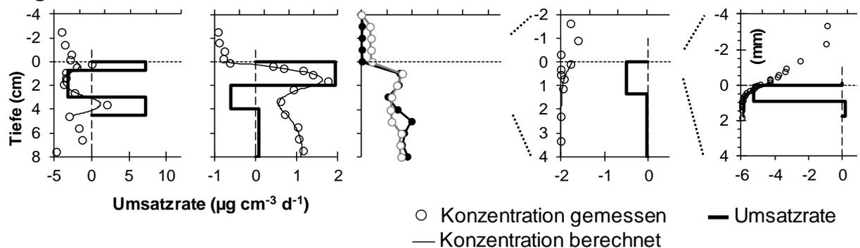
**Abbildung 12** Porenwasserkonzentrationen an der Stelle UHV2 (2012) für  $\text{NH}_4\text{-N}$ ,  $\text{NO}_3\text{-N}$  und DIP (Gelpeeper),  $\text{O}_2$  (Optode), gesamtes gelöstes Fe and Mn (konventioneller Peeper) und berechnete Umsatzraten. (Unterschiedliche Skalierung für  $\text{NO}_3\text{-N}$  und  $\text{O}_2$  beachten)
