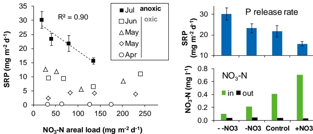
**Abbildung 17** Ergebnisse der Säulenversuche zur P-Rücklösung. Links: Die P-Rücklösungsrate ist nur unter anoxischen Bedingungen abhängig von der Nitratflächenbelastung. Rechts: Im anoxischen Experiment war im überstehenden Wasser kaum Nitrat messbar, obwohl die P-Rücklösungsrate deutlich variierte.
