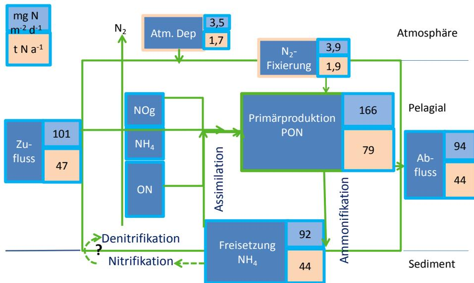
**Abbildung 27** Ein- und Austrag und wichtigste Umsetzungen von Stickstoff (TN) für den Längsee als jeweils flächenbezogene Tagesraten (oben: mg m<sup>-2</sup> d<sup>-1</sup>) bzw. Jahresfrachten (unten: t a<sup>-1</sup>) aus Mittelwerten der Messperiode 2000 - 2012.
