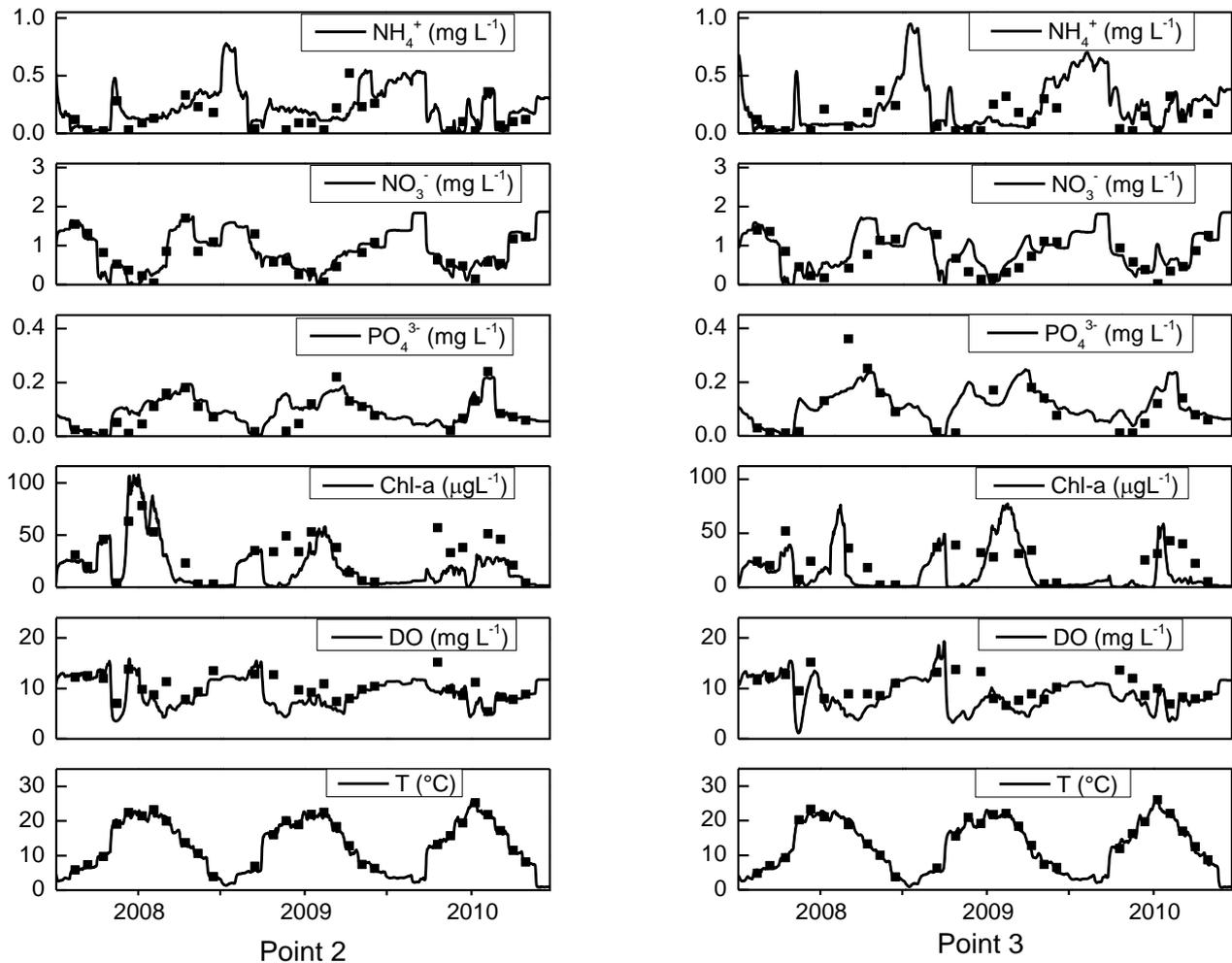
**Abbildung 17** Ergebnisse der Gewässergütemodellierung für die Untere Havel. Die durchgezogene Linie zeigt die Simulationsergebnisse, Punkte die Messwerte. Links UHV-km 7,5 (point 2), rechts UHV-km 11,0 (point 3).
