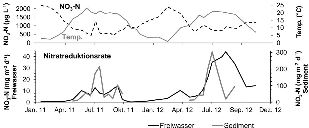
**Abbildung 20** Verlauf von Temperatur und Nitratkonzentration (oben) und Nitratreduktionsraten an der Unteren Havel (UHV1) gerechnet mit gemessenen und interpolierten Zellzahlen für 2011 und 2012.
