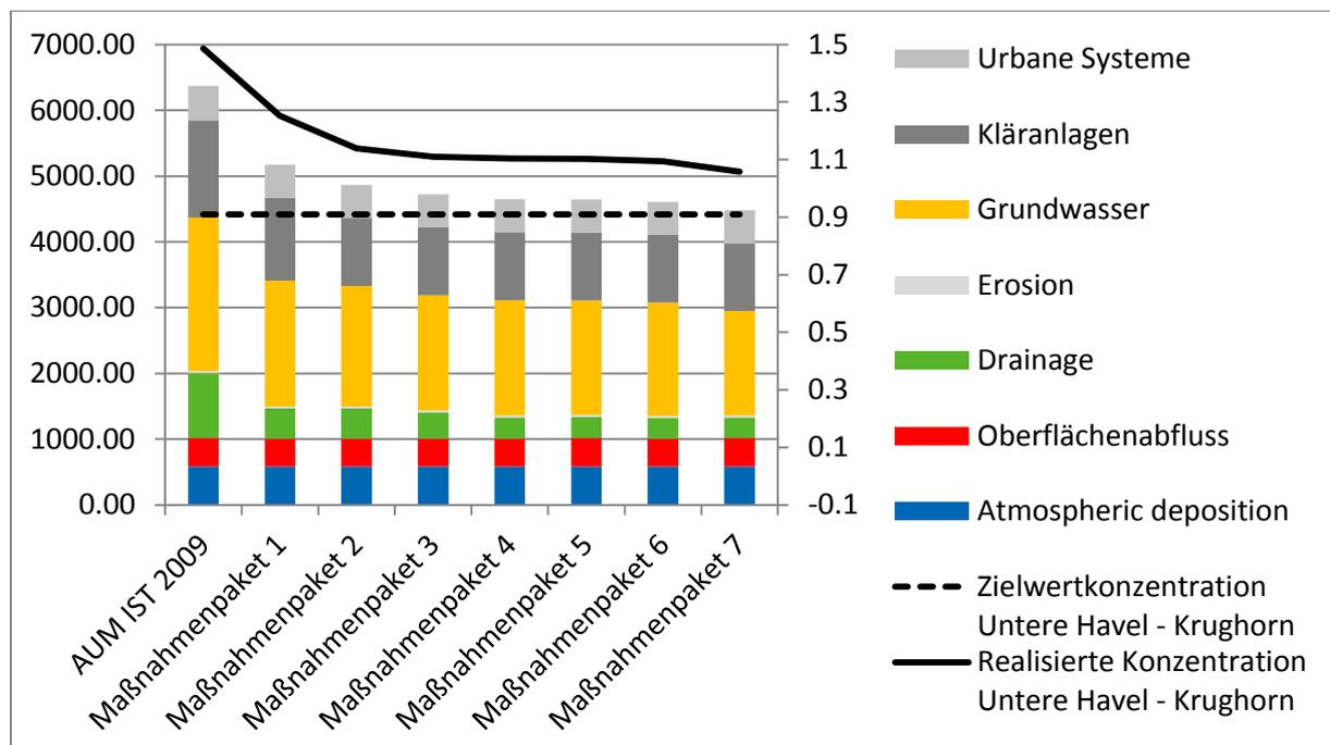
**Abbildung 15** Einträge in ta<sup>-1</sup> der Maßnahmenkombinationen für Stickstoff nach Eintragspfad und erreichte Konzentrationen in mg L<sup>-1</sup> an der Unteren Havel (Krughorn)
