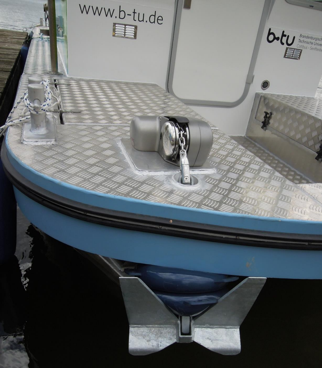
Ankerwinde an Bug und Heck Ankergeschirr mit je 60m Kette
