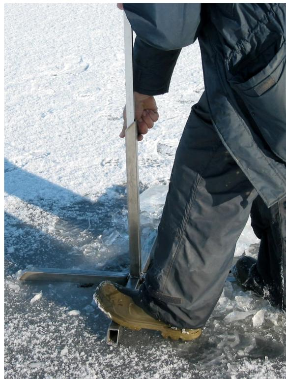
**Abbildung 2:** Der 2004 entwickelte Winkel zur Messung der Lichtintensität unter ungestörter Eis- und Schneedecke (links). Der Fuß mit vertikaler Führung (rechts) hält den Winkel in der vertikalen Position und ermöglicht eine exakte Tiefeneinstellung der Lichtsonde unter Eis.
