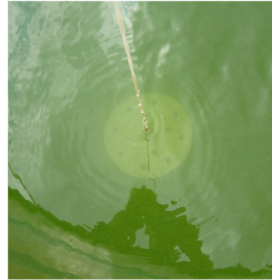
Bild: Sichttiefenmessung mit einer Secchi-Scheibe
