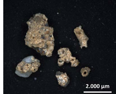
Abbildung 118: Grobsand aus 97–110 cm unter GOK mit Ausfällungen von Sekundärcarbonat
