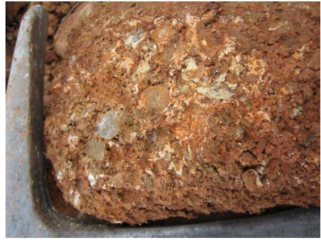
Abbildung 381: Sekundärcarbonat an der Unterseite von Grobbsoden in Profil 117
