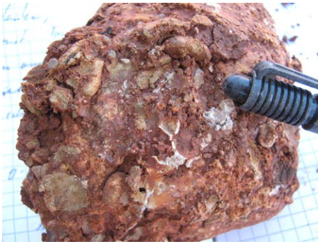
Abbildung 233: Profil 224, Toneintrag und Sekundärcarbonate: rotbraune Tonhäutchen überziehen Feinkieskomponenten und Calcit ausfällungen kitten Feinkies an die Unterseite eines gerundeten Steins
