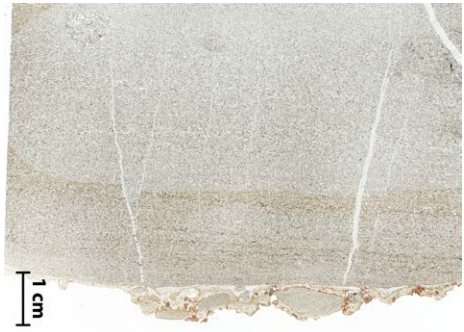
Abbildung 234: Kalksandstein mit Calcitkruste an der Unterseite und ganzseitiger Verwitterungsrinde; siehe Abb. 231, Entnahmetiefe ca. 65 cm unter GOK; im Zentrum enthält der Stein noch Primärcarbonat, im bräunlichen Rand ist der Zement herausgelöst; Verbraunung verursacht einen braunen Verwitterungssaum
