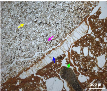
Abbildung 253: Calcitkruste an der Unterseite von Kies (Profil 224, 60–68 cm unter GOK, LPL); gelber Pfeil: unverwitterter Kalksandstein; pinker Pfeil: verwitterter Kalksandstein; blauer Pfeil: sparitischer Calcit; grüner Pfeil: Toncutane
