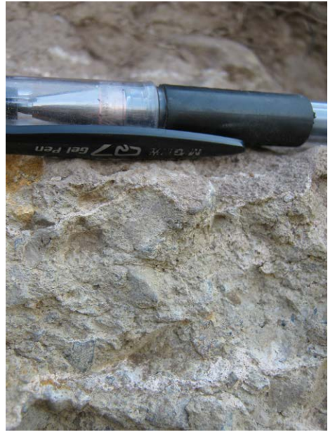
Abbildung 134: Profil 149, Seitenansicht des massiv verkitteten tills , 40 cm unter GOK
