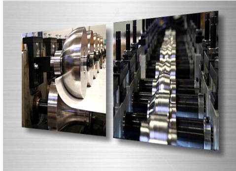
Profilieranlagen aus mehreren aufeinanderfolgenden Walzprofiliergerüsten mit Profilier-Rollen
